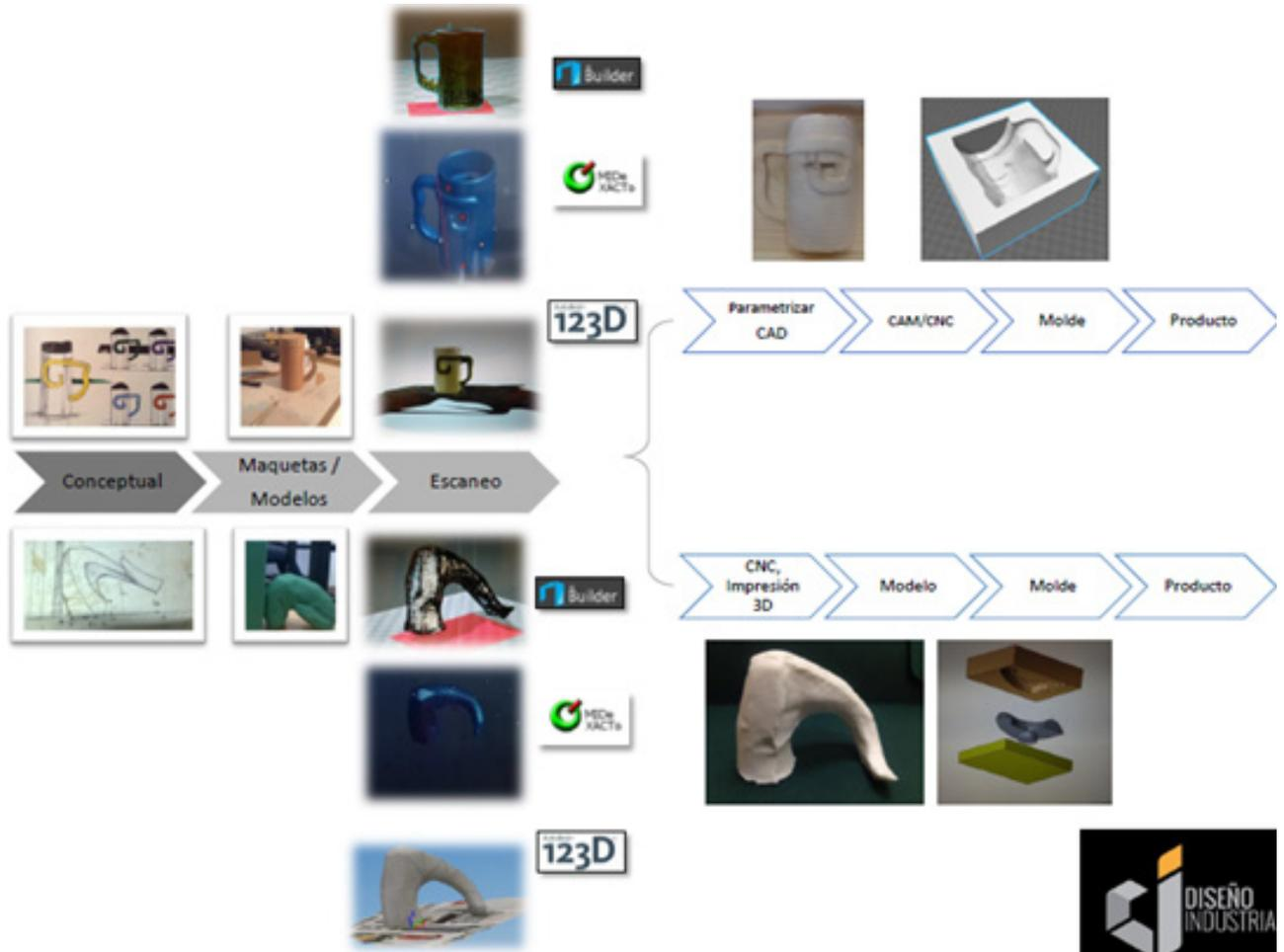
**Figura 8.** Proceso de integración del escaneo 3D, en el desarrollo del producto.
